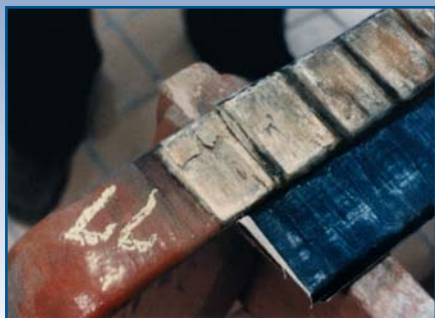
Абразивное истирание изоляции стержня по причине пазовой вибрации (радиальной) в статоре - сравнение с новым стержнем.
